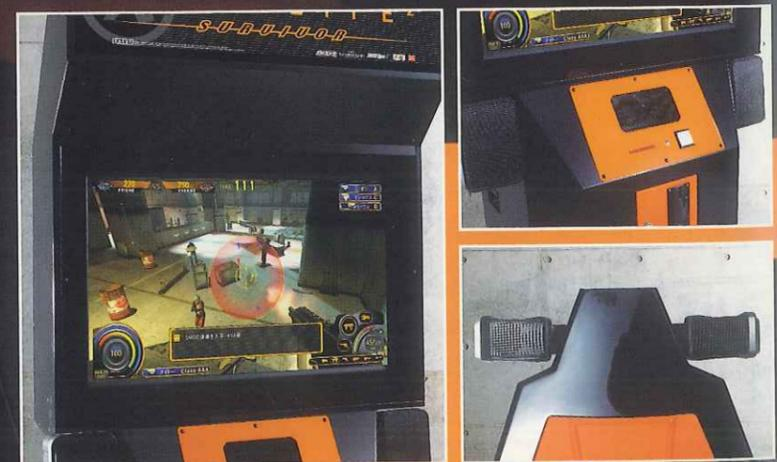
迫力の32インチワイド液晶モニターと、「TypeX+ (タイプエックス・プラス)」の採用で、1360×768の業界最高峰の解像度を実現。また、6個のスピーカーを配置した5.1ch「TX SURROUND」で、臨場感あふれる音響空間を提供します。
